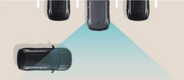
Rear Cross-traffic Collision-avoidance Assist (RCCA)* Memperingatkan apabila ada kendaraan di jalur belakang yang mendekat pada saat mundur dan melakukan pengereman darurat jika diperlukan.
