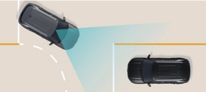
Forward Collision-avoidance Assist with Junction Turning (FCA-JT)* Fitur ini memperingatkan pengemudi ketika sistem mendeteksi ada risiko benturan dari arah depan atau saat ingin berbelok ke kanan, seperti misalnya dengan pejalan kaki atau dengan kendaraan yang tiba-tiba melambat atau berhenti.
