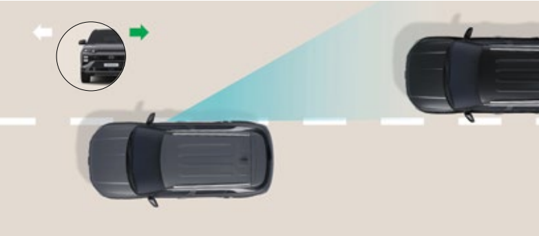
Blind-spot View Monitor (BVM)** Dengan menyalakan lampu sein kiri atau kanan akan mengaktifkan Blind-spot View Monitor (BVM), yang memantau titik buta dan memproyeksikan kondisi secara real time pada tampilan meter cluster.
